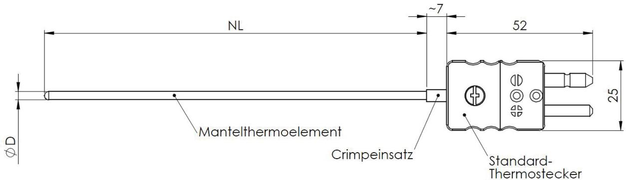
Mantelwerkstoff W2.4816 (Inconel® 600), Durchmesser 1,0 mm
