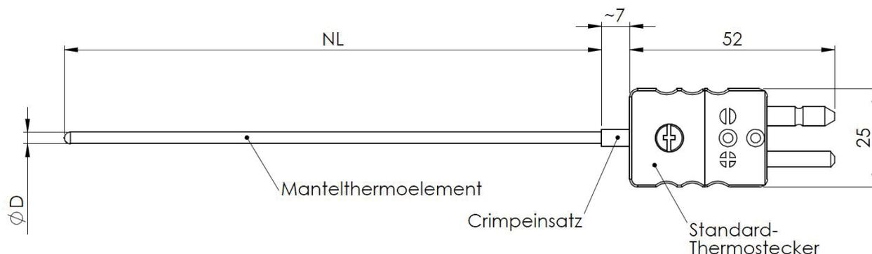
Mantelwerkstoff W2.4816 (Inconel® 600), Durchmesser 1,0 mm
