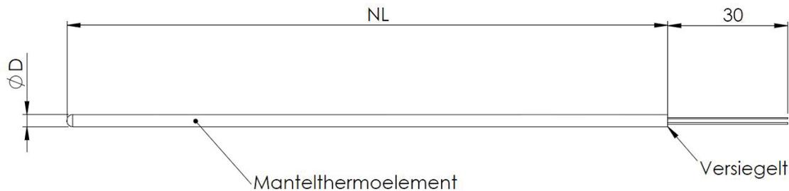
Mantelwerkstoff W2.4816 (Inconel® 600), Durchmesser 1,0 mm
